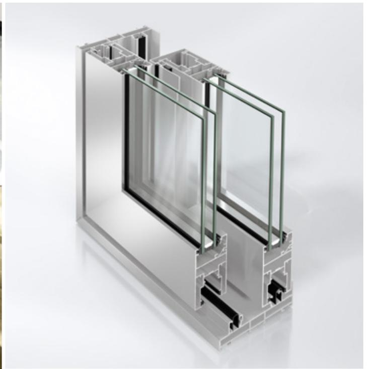
Die ungedämmten Schiebesysteme ASS 28/32 (SC).NI mit schmalen Ansichtsbreiten, geringen Rahmenanteilen und hohen Schiebeanteilen ermöglichen den Einsatz von Gläsern bis zu einer Gesamtstärke von 18, 20 bzw. 24 mm. Die Kombinationsmöglichkeiten der Blendrahmen mit den unterschiedlichen Flügelvarianten gestatten zudem eine hohe Systemflexibilität.
